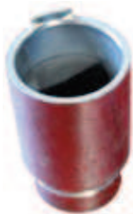
Przedłużacz łapy ramienia podnośnika dwukolumnowego.
