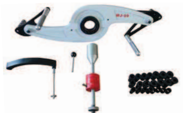
■ Uchwyt wyważarki do kół motocyklowych z siłownikami teleskopowymi.
